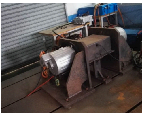
(a) 45 kW 对拖试验台架
